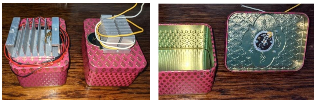
Рис. 3.7 Зовнішній вигляд макетів оптичного стирача (зліва) та розміщення світлодіода на внутрішню сторону кришки (справа).
