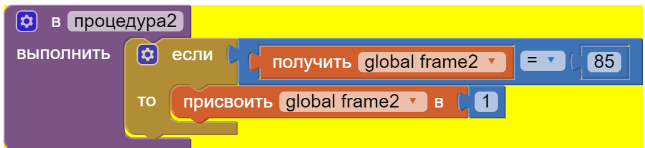
Рис. 2.20 – Процедура 2. Цикл відображення рисунків анімації
