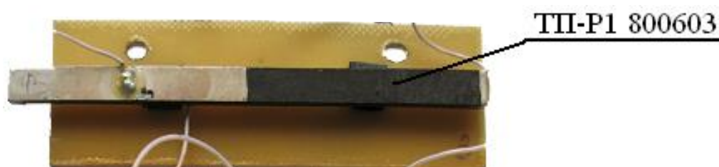
Рисунок 5 - Фото п'єзотрансформатора ТП-Р1 800603
