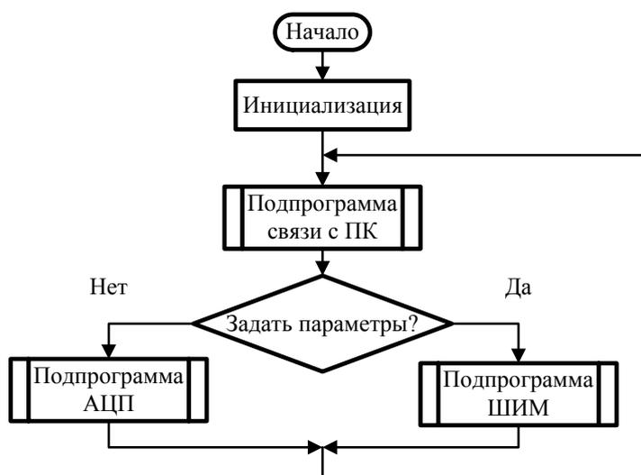
Рис. 6. Алгоритм программы микроконтроллера
