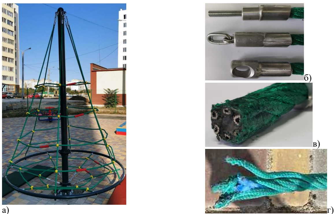
Рис. 1 – Дитячий ігровий канатний комплекс BruStyle LK205 а) вузли кріплення його канатів б) канат поліамідний армований в) канат кручений поліамідний
