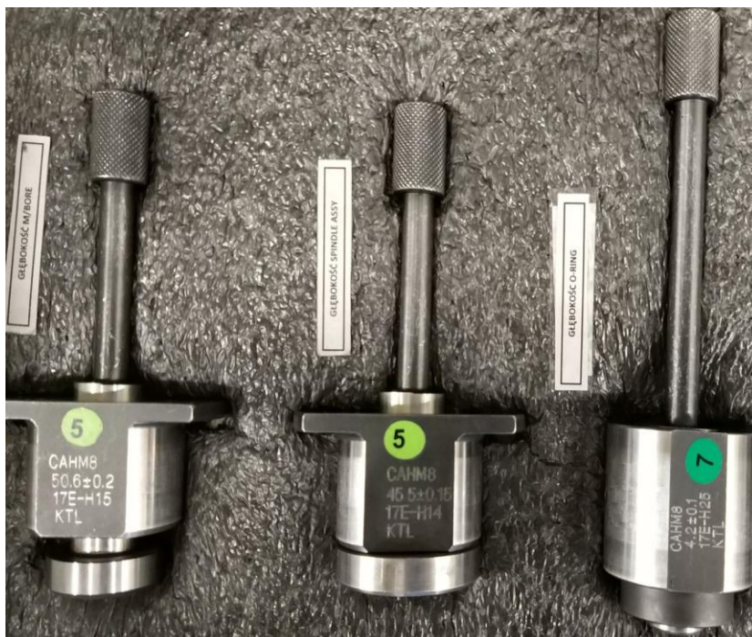
Рис. 2 Вимірювальних прилади, які завжди використовуються при перевірці виготовленого супорта для моделі BMW
