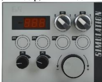
Рис. 2 – Імітатор операторської панелі 4SIM.10-01
