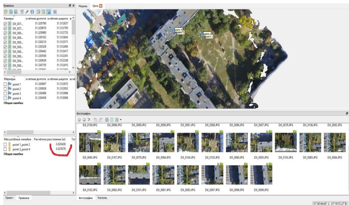
Рис. 3 – Результати виміру нівелірної рейки в ПЗ.
