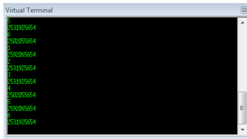
Рисунок 4.8. – Результат моделювання роботи мікроконтролера Atmega 168 обробки даних
