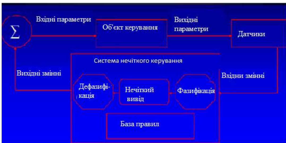
Рисунок 2.7 – Блок-схема роботи Fuzzy logic
