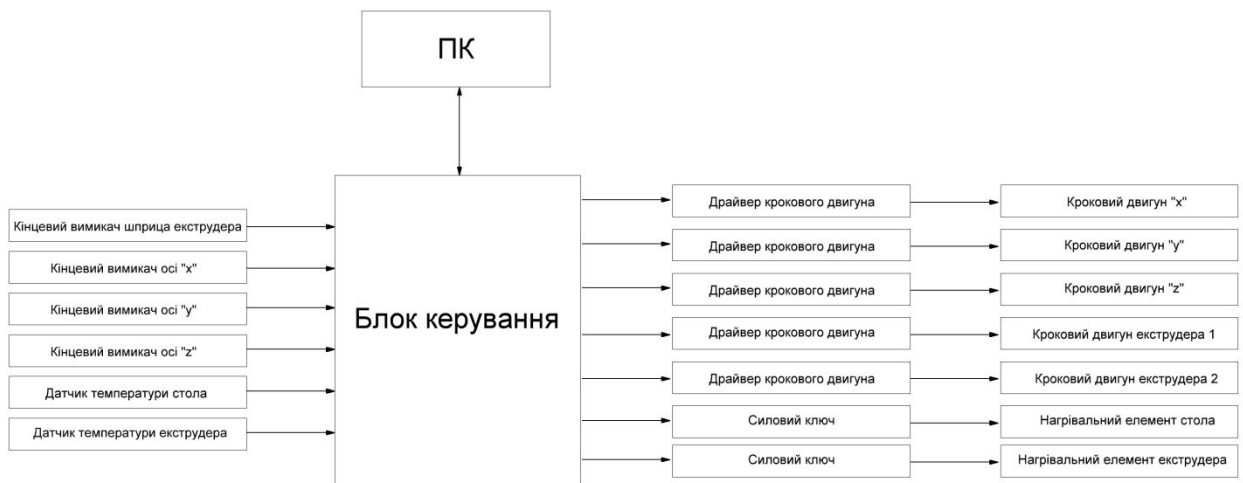
Рисунок 2.1 – Структурна схема тривимірної системи друку
