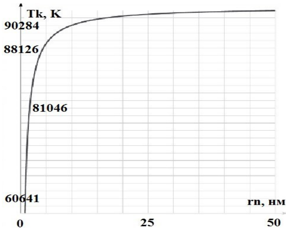
Рис. 2.10 Залежність рівноважної температури T_e від радіусу віскера r_n
